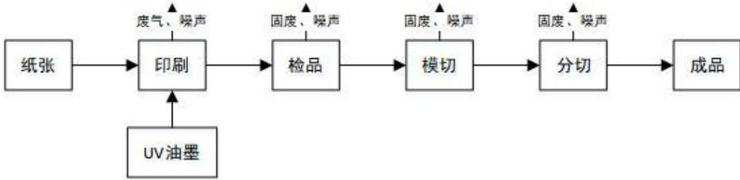
图 2-2 不干胶标签工艺流程图
