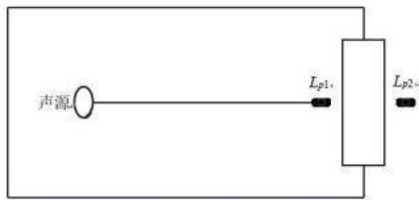
图 4-1 室内声源等效为室外声源图例
