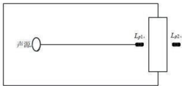
图 4-1 室内声源等效为室外声源图例
