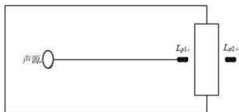
图 4-1 室内声源等效为室外声源图例
