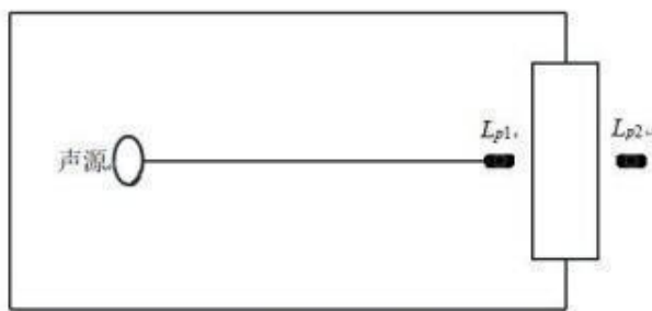
图 4-1 室内声源等效为室外声源图例
