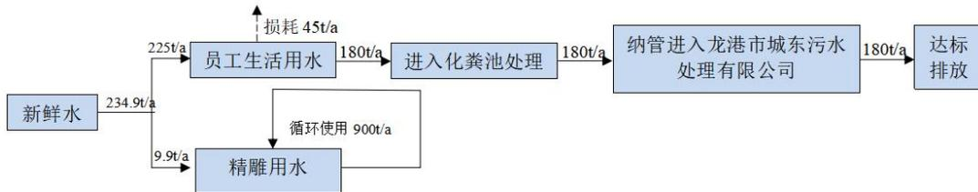
图 2-3 项目水平衡示意图
