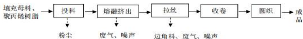
图 2-3 生产主要工艺流程及产污环节
