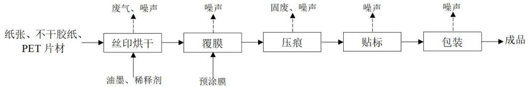
**图 2-1 贴纸、书签印刷工艺流程图**
