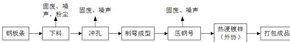
图 2-2 联接板生产工艺流程图
