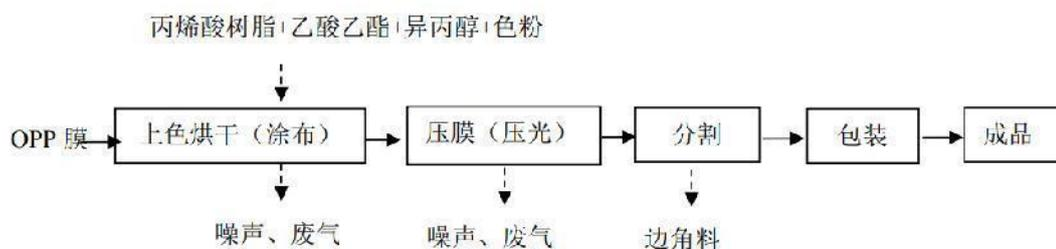
图 2-5 镭射膜工艺流程图
