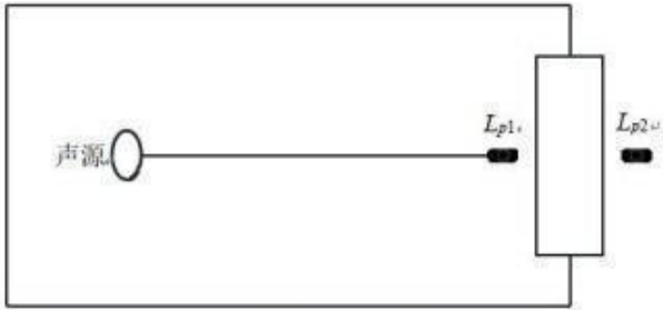
图 4-1 室内声源等效为室外声源图例
