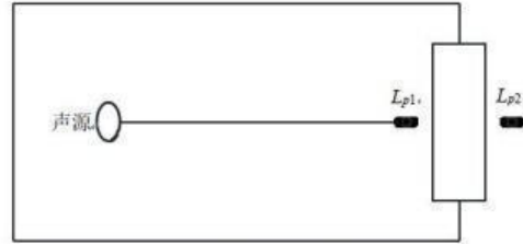
图 4-1 室内声源等效为室外声源图例
