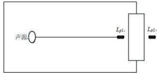
图 4-1 室内声源等效为室外声源图例
