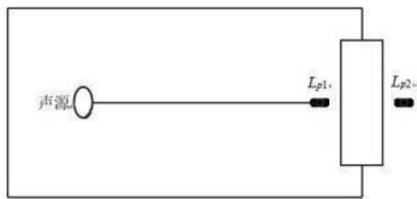
图 4-1 室内声源等效为室外声源图例
