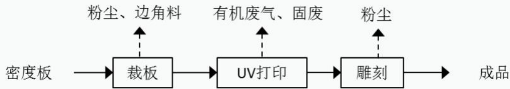
图 2-2 木制标牌工艺流程图
