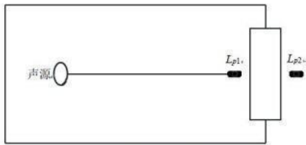
图 4-2 室内声源等效为室外声源图例
