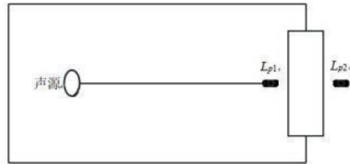
图 4-1 室内声源等效为室外声源图例
